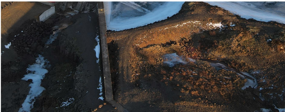
Mynd 7 Rás meðfram steyptri stíflu. Hér sést hvernig rásin víkkar þegar nær dregur fyllingastíflu.
