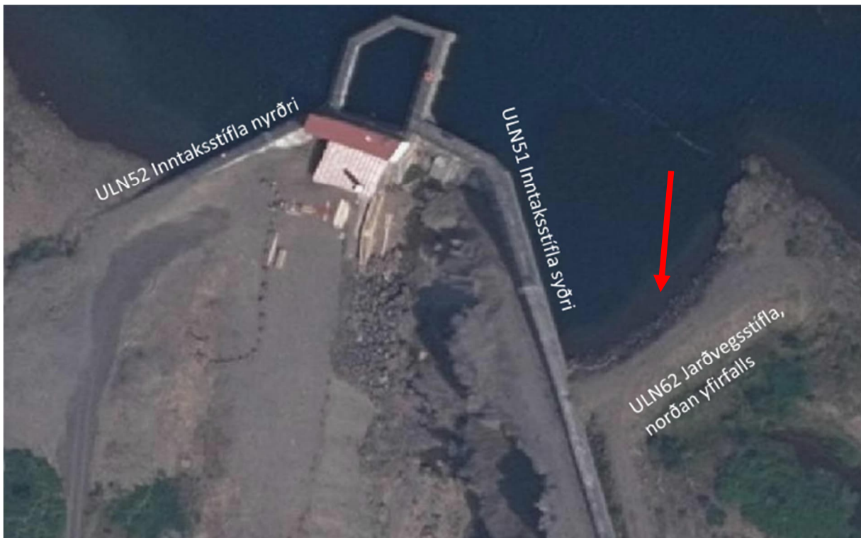
Mynd 1 Stíflur inntakslóns andakílsárvirkjunar, jarðvegsstífla sem um ræðir merkt með rauðu.
